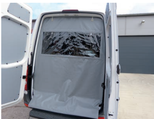
Bâche de retenue avec fenêtre
