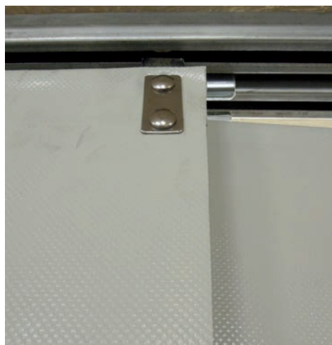
Rideau de protection avec galets de roulement sur le haut
