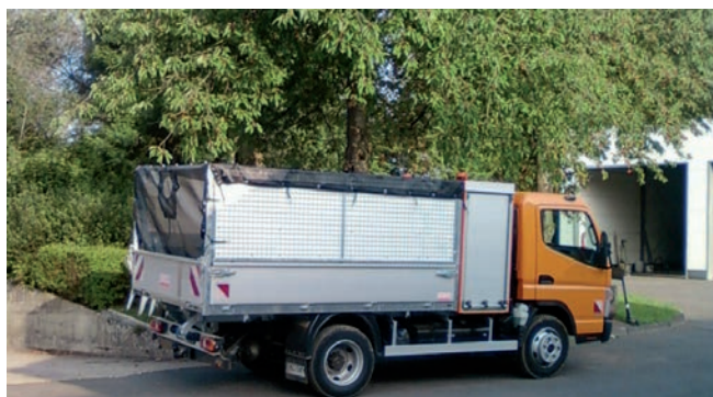
Bâche – filet pour véhicule paysagiste (Equipement par soufflerie)
